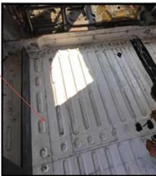
3. Limpiar la zona de fijación tanto la zona de la carrocería como la parte inferior del anclaje fijo aplicando con un papel limpio SIKA ACTIVATOR 100 y una vez aplicado con otro papel limpio forzar el secado.
